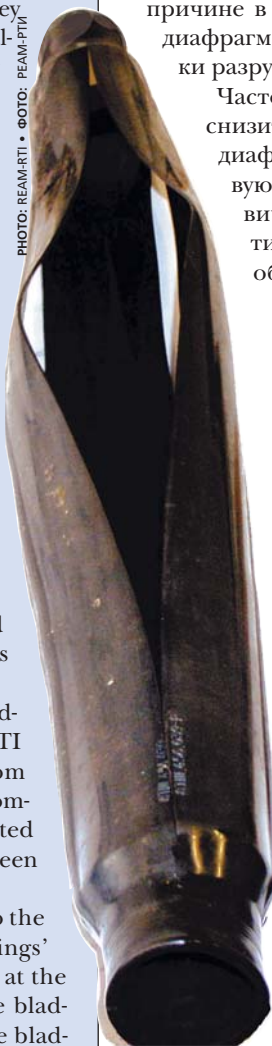
● Fig. 4. The third type of bladder crippling. ● Рис. 4. Разрушение диафрагмы по типу 3.
