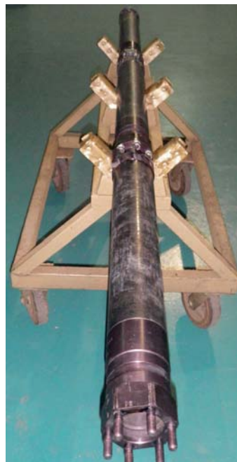
● Photos 2-3 The GPN4-50-2000 assembly process and a fully assembled pump ● Фото 2-3 Сборка насоса и насос ГПН4-50-2000 в сборе
