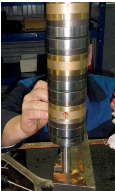
● Photos 2-3 The GPN4-50-2000 assembly process and a fully assembled pump ● Фото 2-3 Сборка насоса и насос ГПН4-50-2000 в сборе
