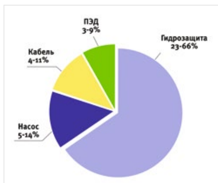
Рис. 6 — Ремонт по причине отказа оборудования
