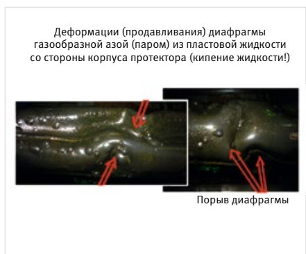
Рис. 7 — Эксплуатационные отказы эластомерных диафрагм
