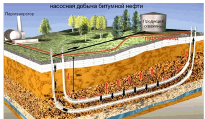
Рис. 2 — Метод парового гравитационного дренажа (SAGD)
